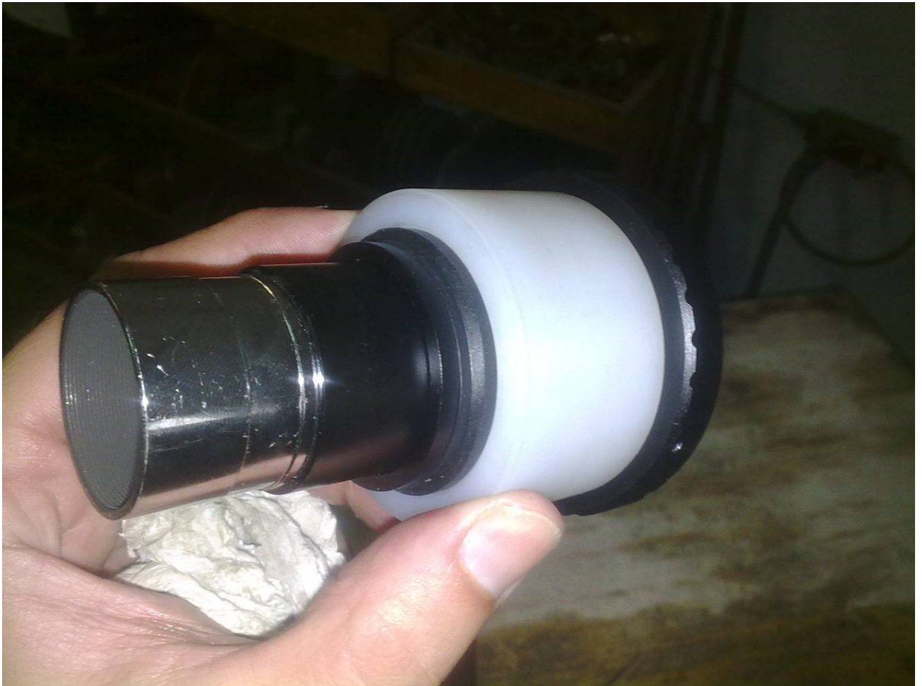
En esta foto se ve el cuerpo del ocular (izquierda) introducido en el hueco del ENGENDRO, en el otro lado (derecha) vemos en adaptador T enroscado al engendro.
