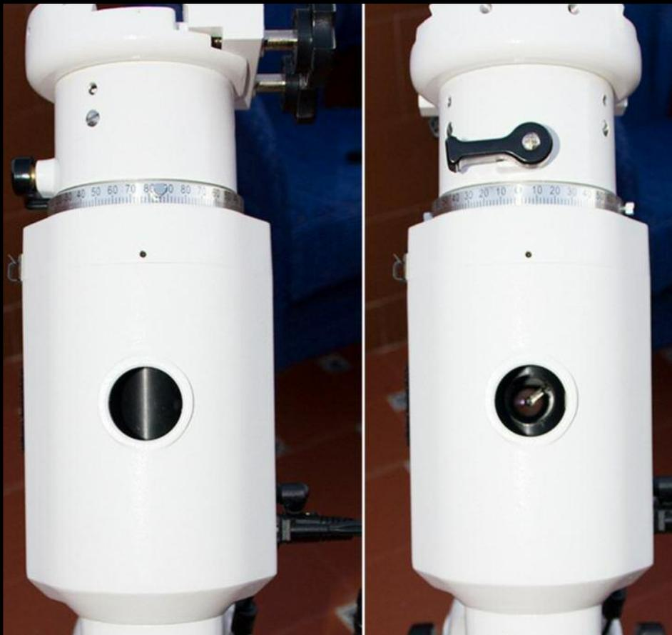
En la imagen de la izquierda el eje Dec. se encuentra en posición de parking y la barra que lo atraviesa no permite pasar la luz. Por el contrario, en la fotografía de la derecha, el eje Dec. se encuentra en horizontal, con lo que la barra que lo atraviesa rota con él y abre una pequeña apertura por la que podemos observar con el buscador de la polar.
