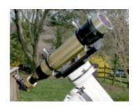
poder ver algún detalle en la superficie de nuestro astro rey. Normalmente el telescopio es mejor a mayor abertura y menor paso de banda, es decir, si tenemos un telescopio que nos marca en Hidrógeno alfa un paso de banda de <l Angstrom nos dará menor resolución (veremos menos detalles) que con uno que nos de 0,5 Angstrom.
