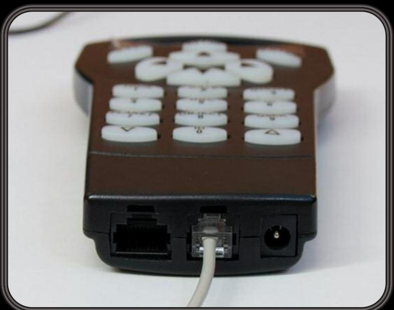
Si nos fijamos en la fotografía del mando al principio del post, observamos que para conectar el mando con la montura utilizamos la conexión de la izquierda pero para conectarlo al PC utilizaremos la del centro.
