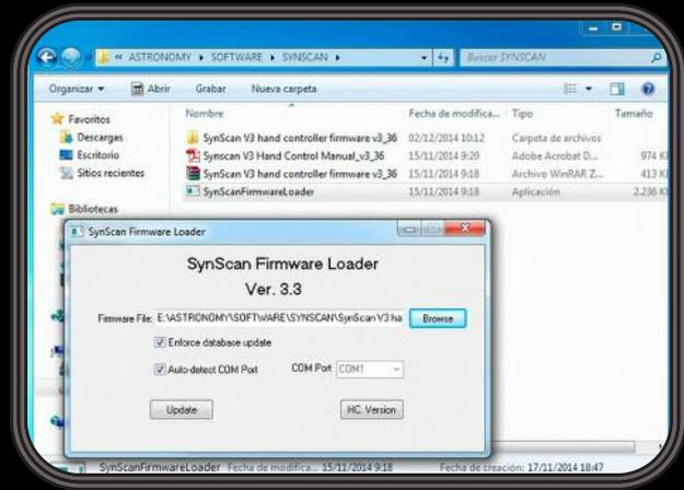
4.- Hacemos click en el botón de HC. Version para comprobar la conexión con el mando y que nos autodetecte el puerto COM. La primera vez a mi me suele dar error y me aparece un mensaje como el que veis en la primera imagen. Le damos a Aceptar y de nuevo al HC. Version y nos aparecerá el SynScan Firmware Loader como en la segunda imagen.
