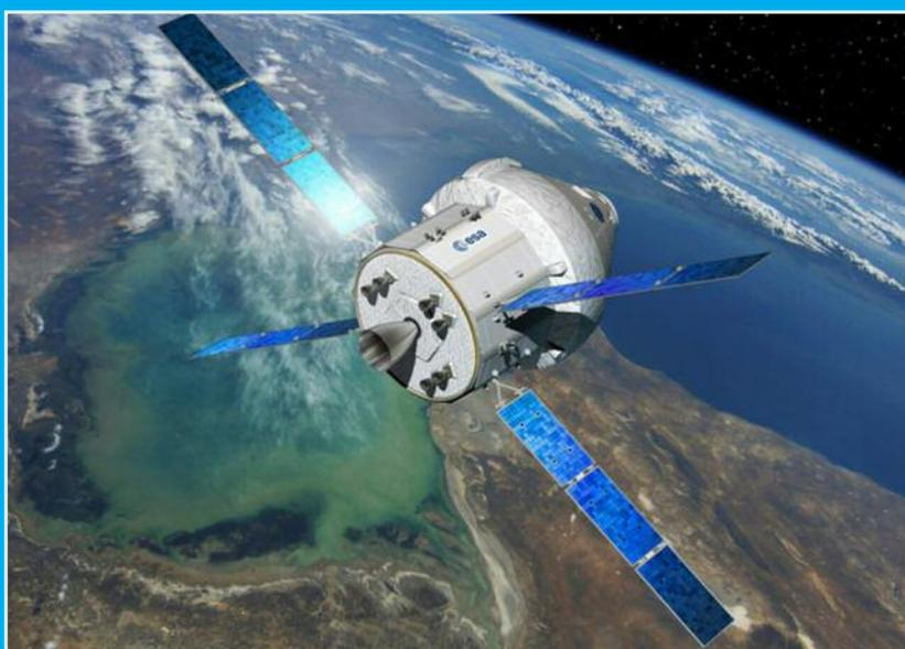
El módulo de servicio europeo proporcionará a la Orión el sistema de propulsión y control de posición, así como la potencia eléctrica (a través de paneles solares), así como el control térmico y el suministro de agua, oxígeno y nitrógeno para los astronautas. El módulo permanecerá acoplado a la cápsula hasta justo antes del inicio de las maniobras de retorno a Tierra.
